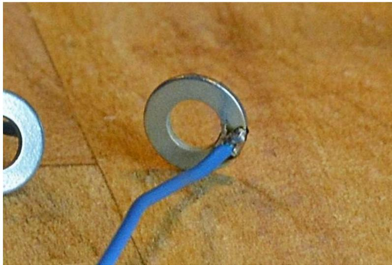
Las arandelas o rondanas se conectarán a los pines de entrada del Arduino, es por ello que se tiene que soldar cada cable a su arandela correspondiente.
