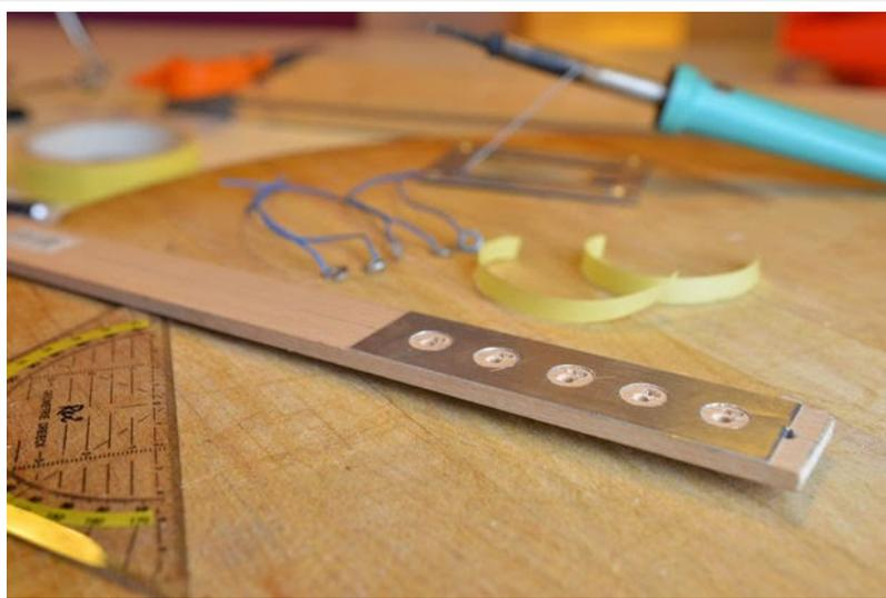
Pega la placa de aluminio a la base de madera utilizando dos tiras de Cinta Doble Cara como se observa en las imágenes. Pon mucha atención al colar ambas placas, que coincidan exactamente los orificios uno sobre el otro.
